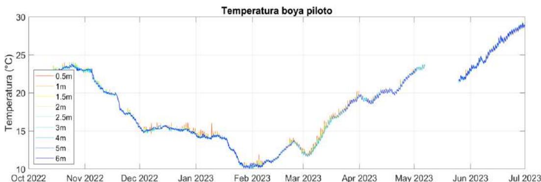
Figura 5: Serie temporal de temperatura obtenida a cada profundidad por los sensores de la boya SMLG, calibrados con los datos de CTD obtenidos por el IEO-CSIC.
